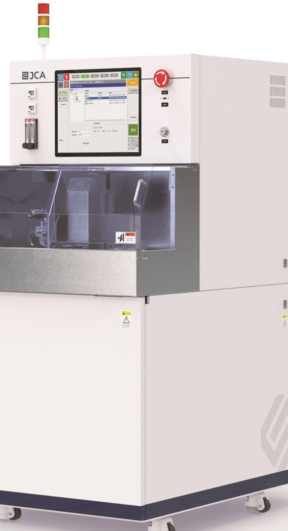
自动对准、自动切割、自动刀痕检测功能，减少操作人员工作量，有效提高生产效率。
